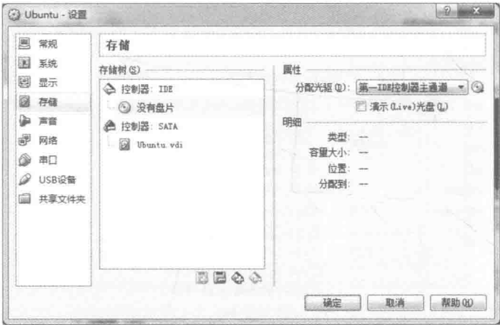
图 3-9 VirtualBox 中存储配置
