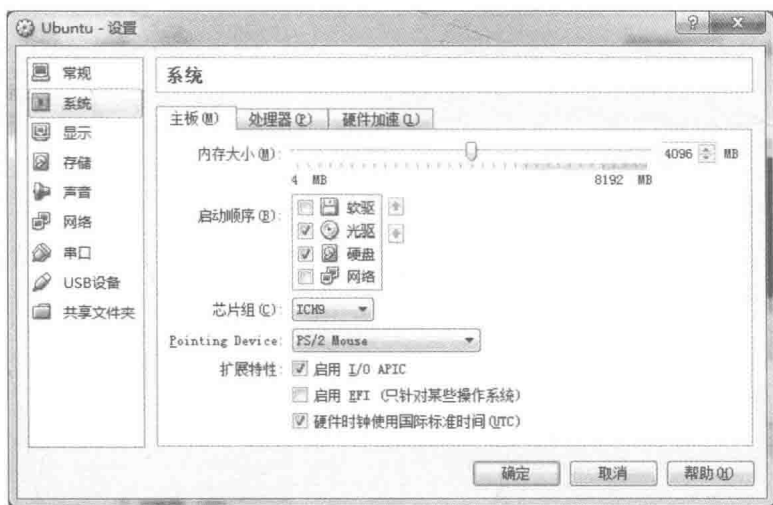
图 3-7 VirtualBox 中主板相关配置
