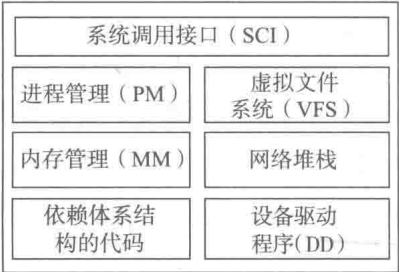
图 5-2 Linux 内核体系结构透视图
