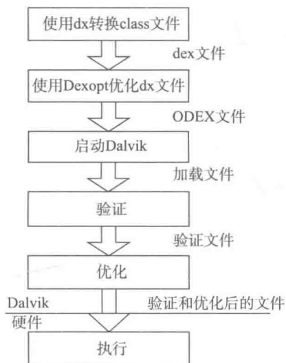
图 6-1 应用程序在 Dalvik 虚拟机中的执行流程
