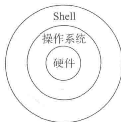
图 2-28 Shell 在计算机系统的位置
