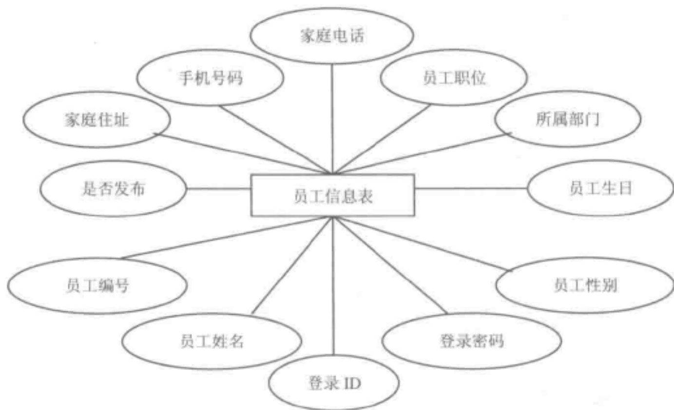
图 11-14 员工信息实体 E-R 图
