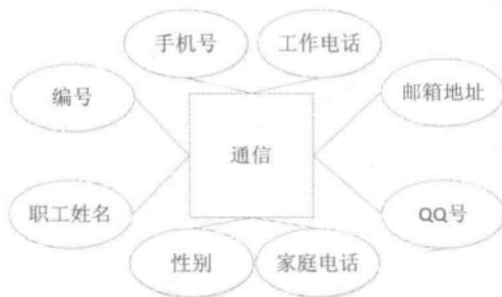
图 3-16 通信的实体 E-R 图
