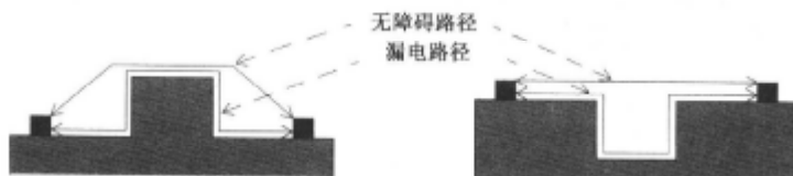
图 9.2 漏电路径和无障碍路径长度
