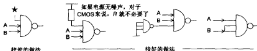
图 6.12 连接未用的输入端
