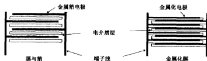
图 3.10 膜电容器的结构
