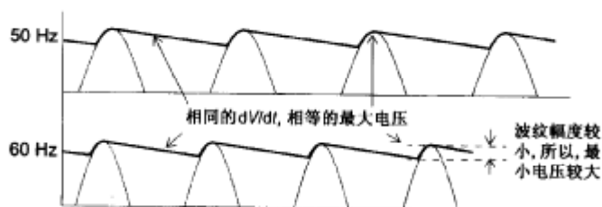
图 7.8 纹波电压与频率的关系
