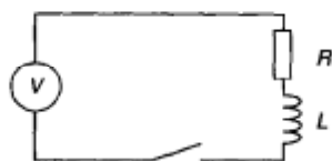
图 3.23 串联电感器-开关电路
