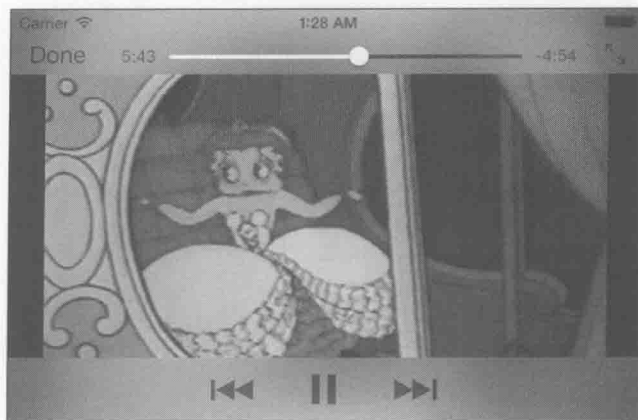
图 8-3 MediaPlayer 框架简化了应用程序的视频回放。这个类既可以播放设备之外的串流视频，也可以播放存储在本机的固定视频资源。支持的视频格式包括 H.264 Baseline Profile Level 3.0 视频（每秒最多 30 帧，每帧最大 640 \times 480 ）以及 MPEG-4 Part 2 视频（Simple Profile）。以 .mov、.mp4、.mpv 及 .3gp 为扩展名的大部分文件都可以播放。支持的音频格式包括 AAC-LC 音频（采样率最大 48KHz）以及 MP3（MPEG-1 Audio Layer 3，采样率最大 48KHz）立体声
