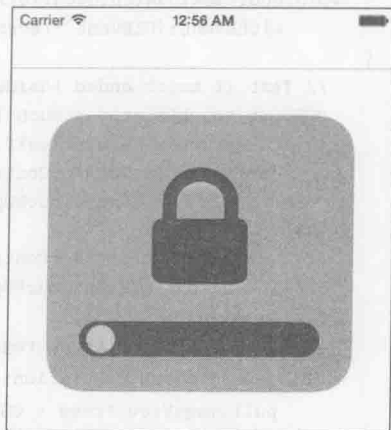
图 2-8 这是个简单的锁定控件，如果用户能将滑块拖过至少 3/4 的轨道长度，那么该控件就会解锁并消失
