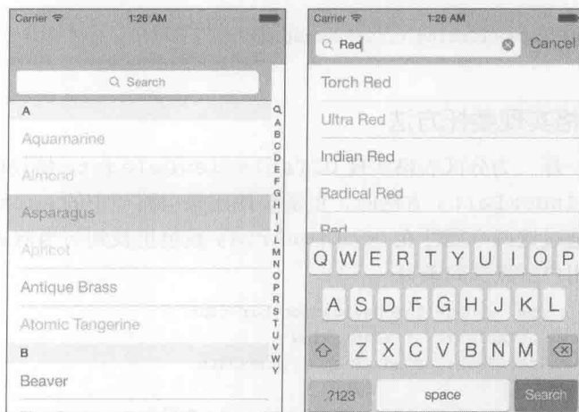
图 9-7 开始搜索时，必须滚动到表格顶部。作为头部视图的搜索栏会出现在表格中的首个位置上（如左侧截图所示）。用户点击搜索栏之后，就会将其激活，此时搜索栏会跳到导航栏里，而表格则会根据用户输入的搜寻标准来展示与之匹配的条目（如右侧截图所示）
