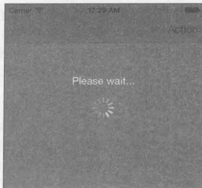
图 3-4 装配了 UIActivityIndicatorView 的模态视图，可以在程序执行同步操作（或称阻塞式操作）时向用户展示反馈效果。开发实际的应用程序时，要记得给用户提供一种操作方式，令其在无须强行退出程序的前提下，能够把比较耗时的任务取消掉
