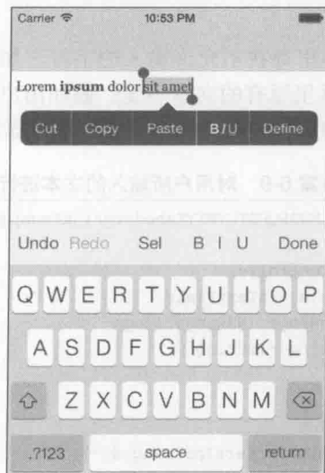
图 6-8 UIResponderStandardEditActions 协议定义了常用的文本编辑命令，开发者可以在自己设计的用户界面里调用这些命令。系统菜单中会自动出现 BIU 选项，而键盘上方那个辅助视图（accessory view）也为这三个选项分别提供了三个按钮。用户可以通过辅助视图里的 Sel 按钮来选取全部文本，也可以通过 B、I、U 等按钮对文本运用（或者从文本中取消）加粗、变斜体以及加下划线等效果
