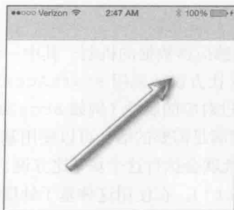
图 14-1 只需通过反正切函数对 x 轴和 y 轴的力向量稍作数学运算，就可以找到真实的“上”方向。在本例中，无论用户如何调整设备方向，程序的箭头总是指向真正的上方
