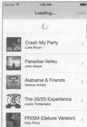
图 9-8 开发者很容易就能给表格添加下拉刷新功能。用户通过向下滑拽表格来请求程序更新其中的数据
