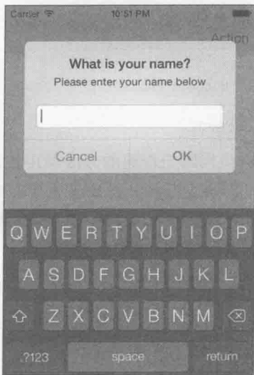
图 3-2 这种警告视图没有使用 UIAlertView 类里传统的回调机制，而是通过开发者在创建按钮时所指定的块来响应用户的操作
