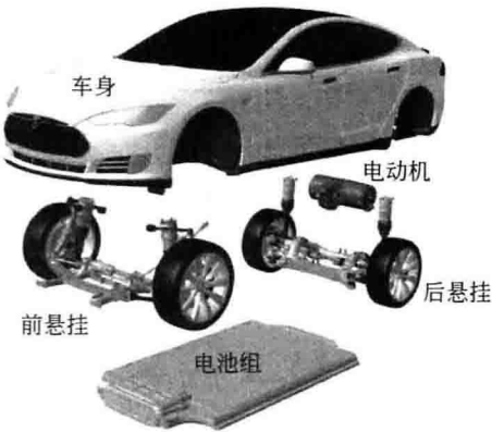
图 4-1 纯电动汽车的构造
