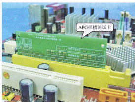
图 17-8 AGP 插槽测试卡及 PCI 插槽测试卡
