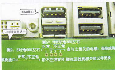
图20-7 USB接口对照阻值测试卡的引脚
