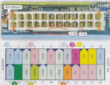
图24-2 24脚电源接口电路的基本结构及引脚功能示意图
