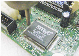
(a) 用热风焊枪加热
