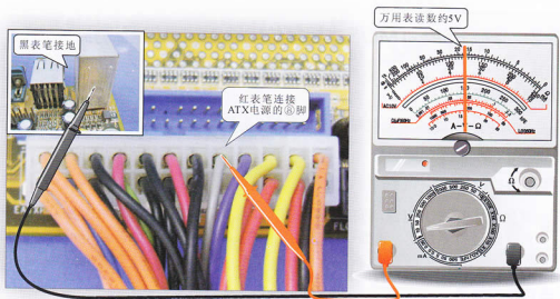
图12-13 万用表检测ATX电源的⑤脚电压
