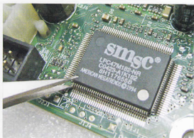
(b) 用镊子取下损坏的I/O芯片
