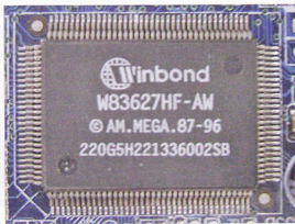
图10-8 集成有开机电路的I/O芯片
