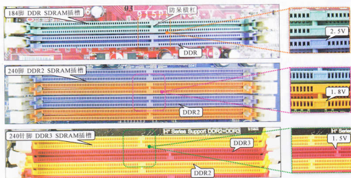
图 16-3 内存插槽的区分方法
