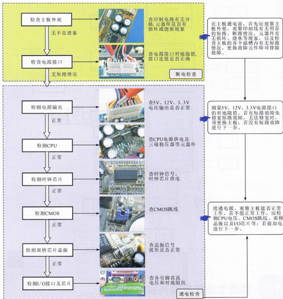
图1-23 主板的基本检修流程
