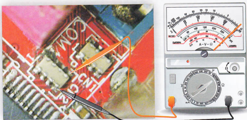
图 22-8 电容的检测
