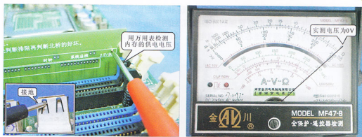
图 16-11 内存供电电压的检测
