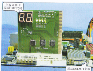
图 15-10 使用主板诊断卡诊断昂达N61GT主板故障
