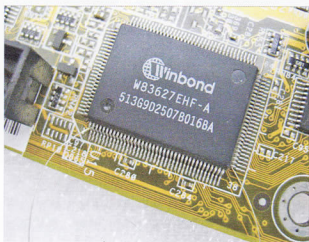
图5-13 将铁丝穿入I/O芯片的一排引脚内
