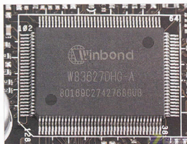
图10-8 集成有开机电路的I/O芯片
