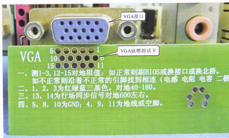
图 25-7 VGA 接口与 VGA 插槽测试卡的对照
