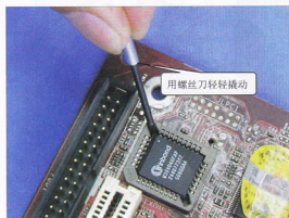
图14-10 拆解PLCC封装形式的BIOS芯片
