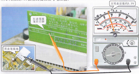
图9-19 检测PCI插槽的复位信号电压值
