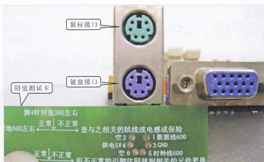
图 19-11 PS/2 接口对照阻值卡
