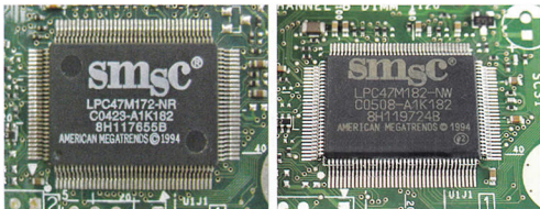
图 5-4 LPC47M172 型号和 LPC47M182 型号的 I/O 芯片
