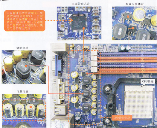
图15-1 昂达N61GT主板的CPU供电电路
