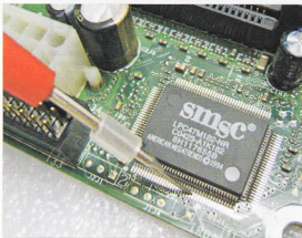
(a) 改造后的示波器探头
