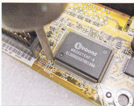
(a) 用热风焊台加热
