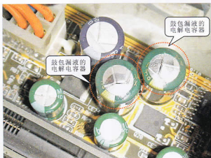
图 15-17 CPU 供电电路中损坏的电容器
