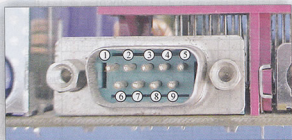
(a) 串口接口引脚实物外形
