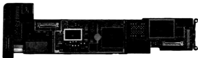
图 1-8 图 1-7 中 Apple iPad 2 的逻辑主板。图中突出了 5 块集成电路。中部的大 IC 是 Apple A5 芯片，包含了一个主频 1GHz 的双核 ARM 处理器和 512MB 的主存。图 1-19 是 A5 中处理器芯片的照片。左边大小相当的芯片是 32GB 的非易失性的闪存芯片。两块芯片之间的空间可以安装第二块存储器来扩展 iPad 的存储容量。A5 右边的芯片包含了电源控制和 I/O 控制芯片（iFixit 友情提供，www. ifixit. com）
