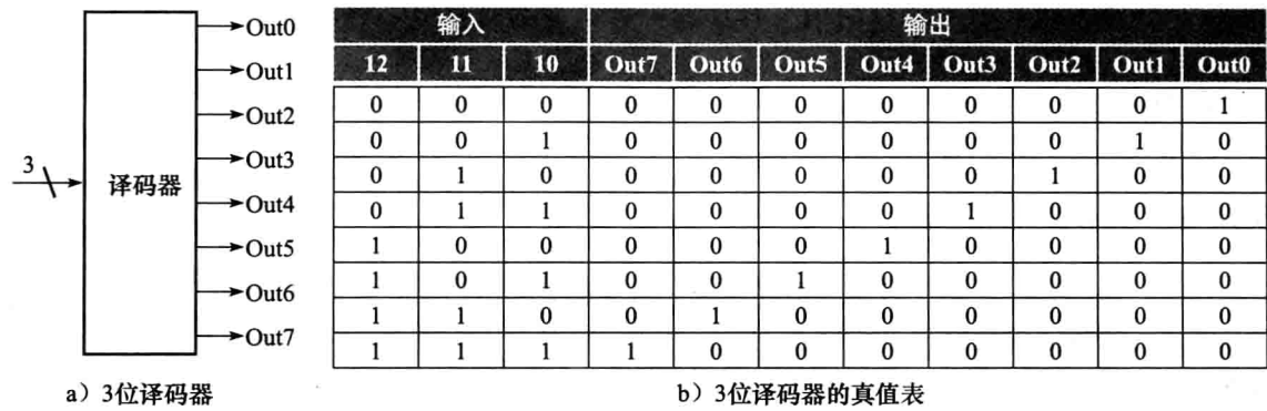
图 B-3-1 一个3 位译码器包含 3 个输入（12、11、10）和 8 个输出（Out0 ~ Out7）。正如真值表所示，只有与输入信号对应的二进制数据相关的输出被置为 1。译码器输入端的 3 表示输入信号为 3 位位宽
