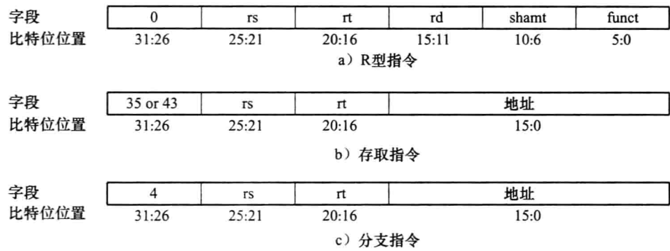
图 4-14 三种指令类型（R 型、存取和分支）使用的两种指令格式。后面我们马上会讲到，跳转指令使用另一种格式。a) R 型指令的格式，操作码为 0，寄存器操作数有 3 个：rs、rt 和 rd。rs 和 rt 字段为源操作数，rd 字段为目的操作数。funct 字段指出 ALU 功能，由前面设计的 ALU 控制单元译码。我们实现的 R 型指令有 add、sub、AND、OR 和 slt。shamt 字段只用于移位指令，本章中暂不考虑。b) 取数指令（操作码 = 35 10 ）和存储指令（操作码 = 43 10 ）的格式。rs 寄存器作为基址与 16 位的地址字段相加以得到访存地址。对取数指令，rt 是取出数据的目的寄存器。对存储指令，rt 是要存入存储器的数据所在的寄存器。c) 相等则分支指令（操作码 = 4）的格式。rs 和 rt 是源寄存器，用于比较是否相等。16 位地址进行符号扩展、移位后与 PC + 4 相加以得到分支目标地址
