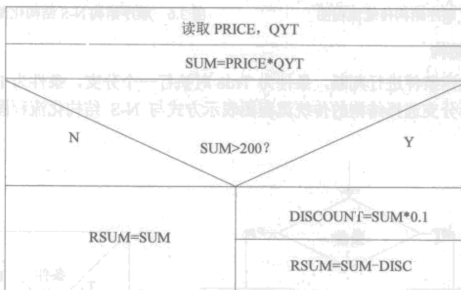
图 3.4 用 N-S 结构化流程图描述商家给客户打折的算法
