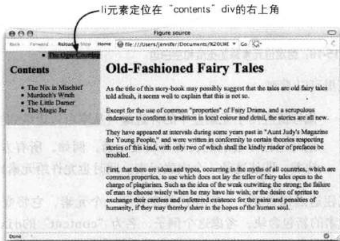
图15-20：定位元素变成它们包含的元素的包含块。本例中，列表项相对于所在的div元素定位，而不是整个网页
