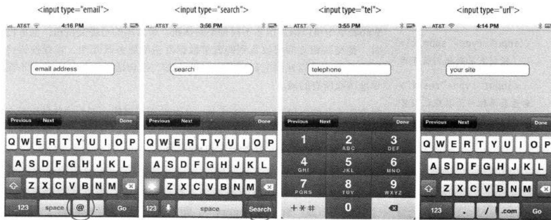
图9-5: iOS上的Safari在输入类型的基础上提供了自定义的键盘
