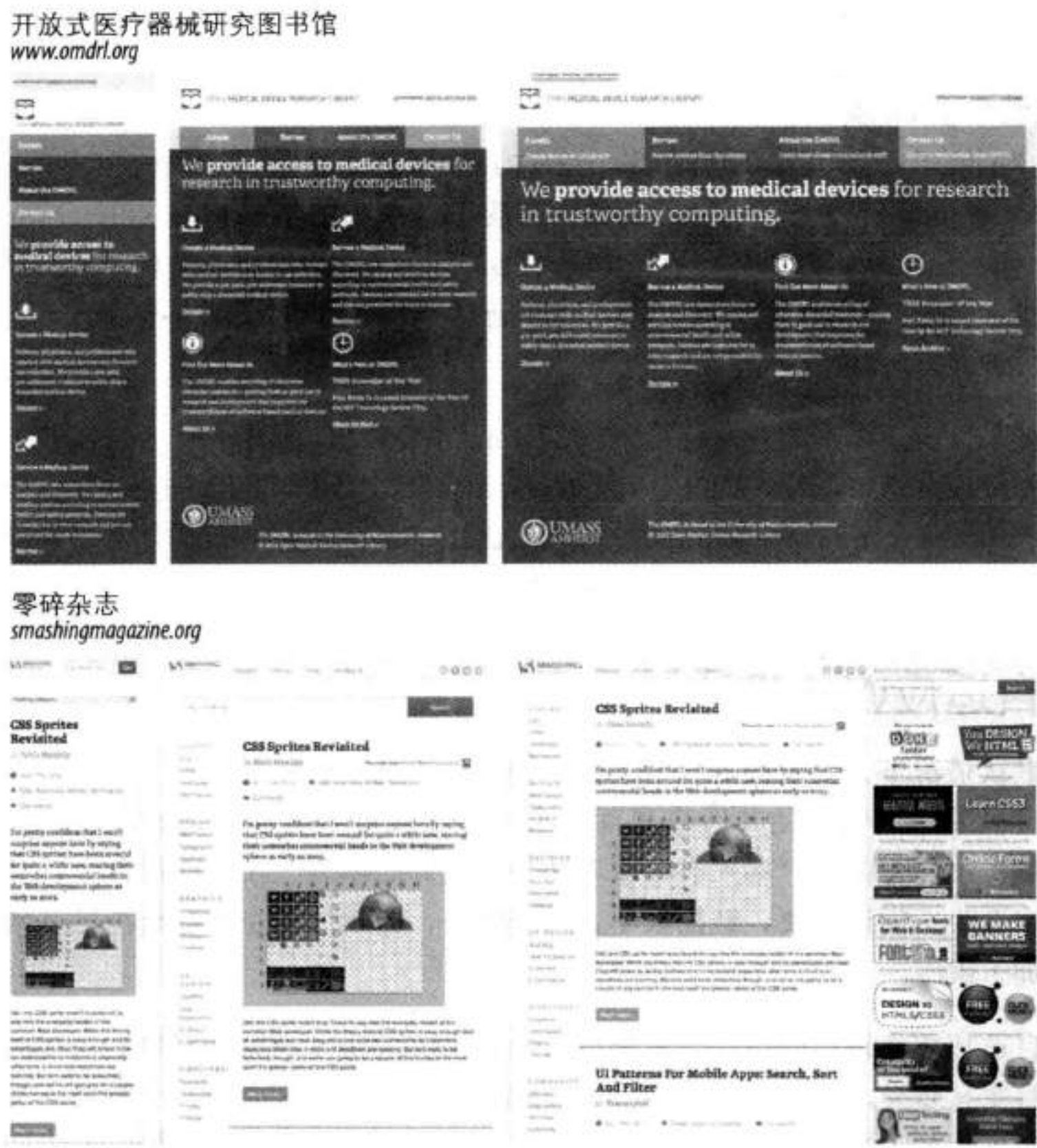
图3-3：随浏览器窗口大小自适应网站的布局变化
