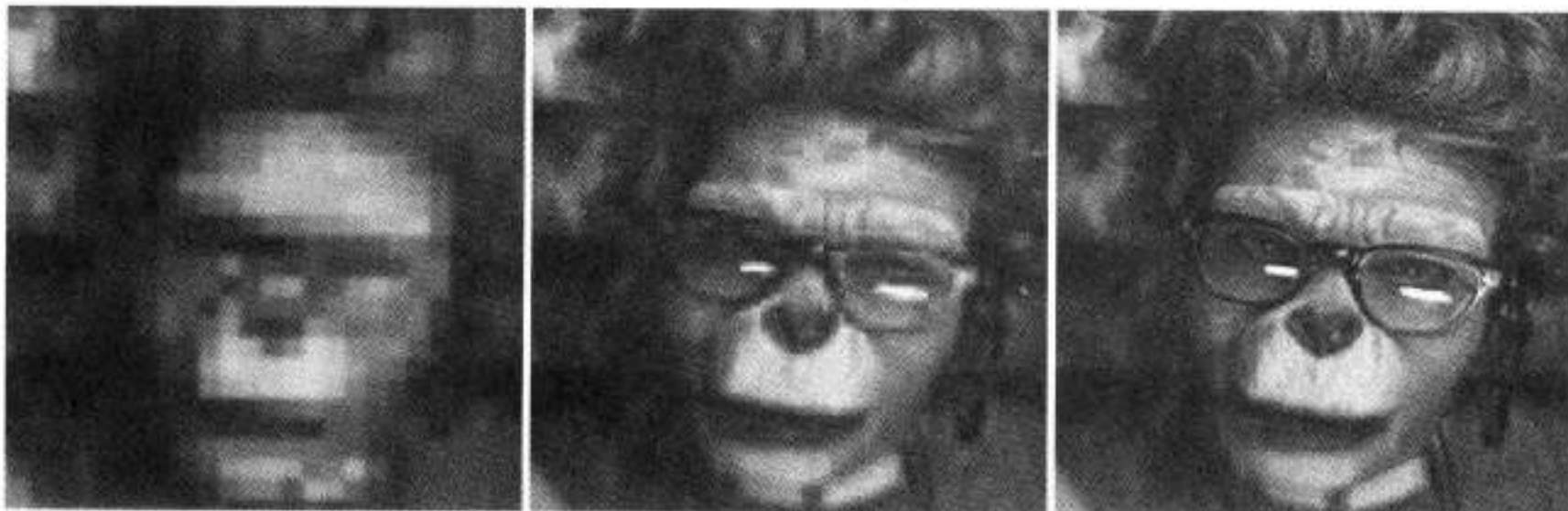
图21-10：渐进式JPEG图像以一系列路径渲染
