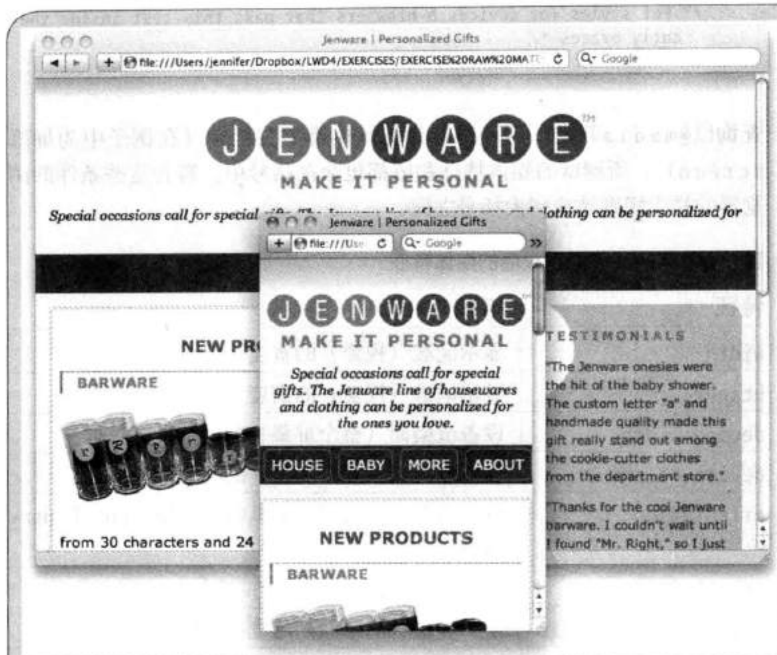
图18-11: max-width属性使得图像与它所在的容器同比例缩小
