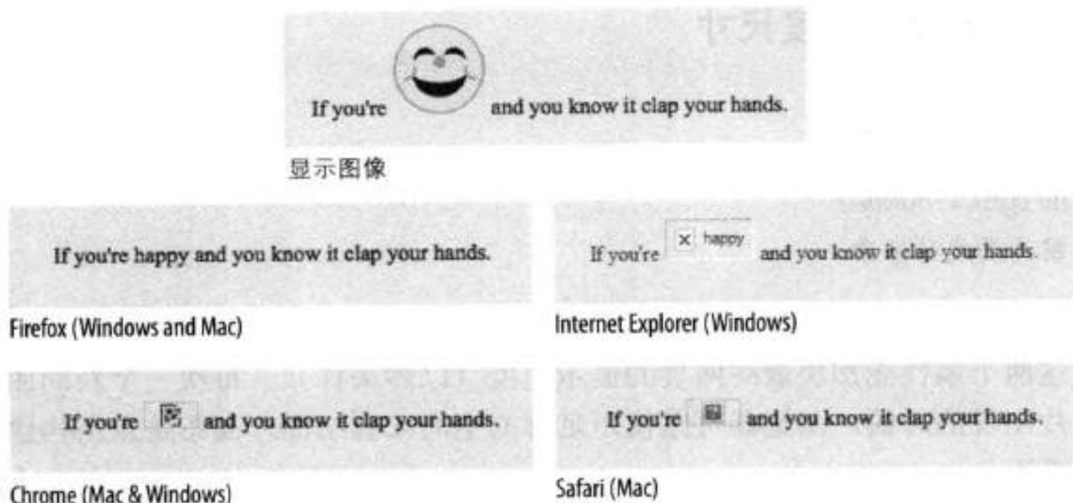
图7-3：当图片不可用时，大多数浏览器在图片位置显示替换文本（以图标或内联文本的方式），然而Macintosh OS X下的Safari是一个例外
