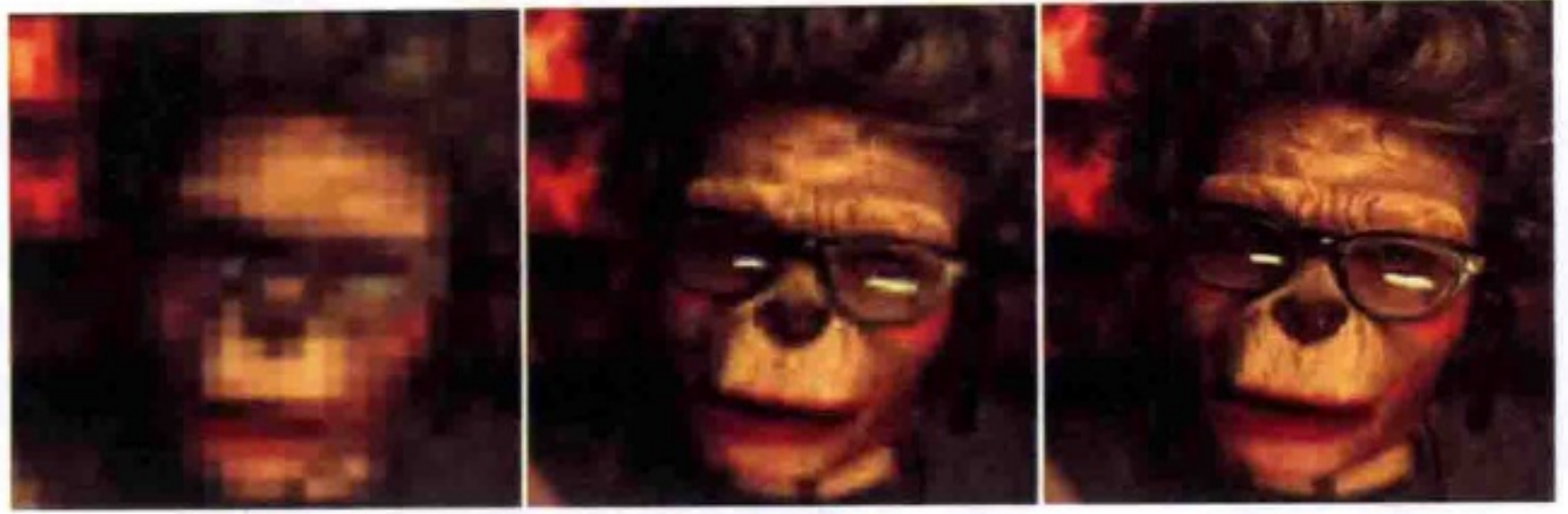
图21-10：渐进式JPEG图像以一系列路径渲染
