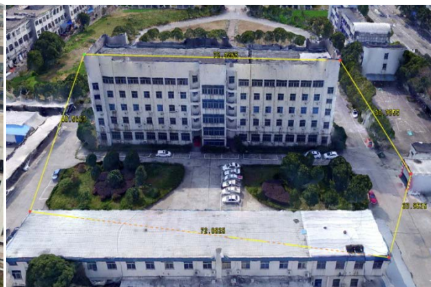
图 106 折线段长度的测量
