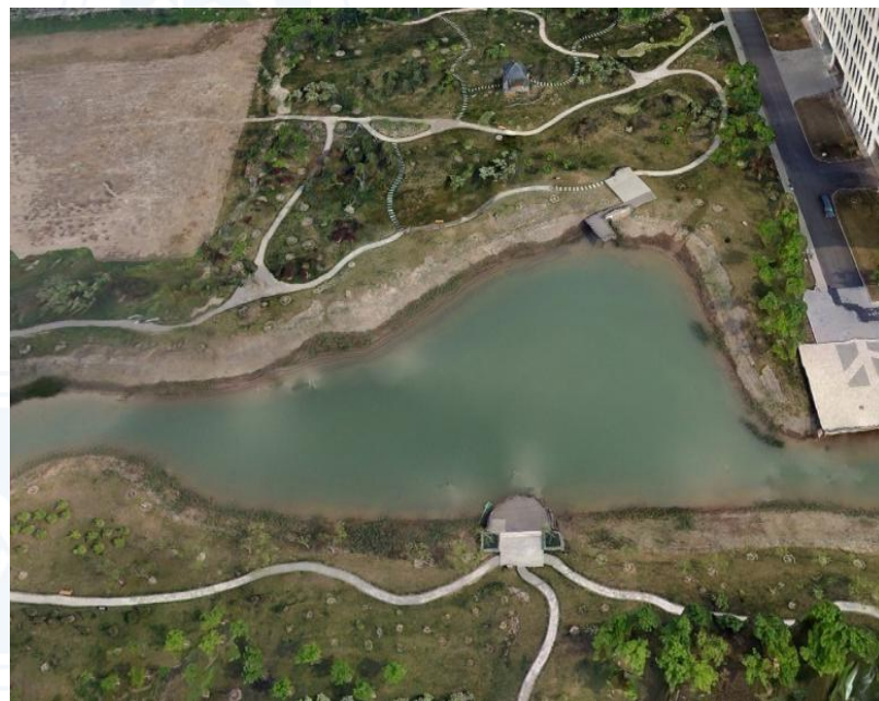
水域孔洞区域修复后使用Pixel-Mosaic进行纹理贴图
