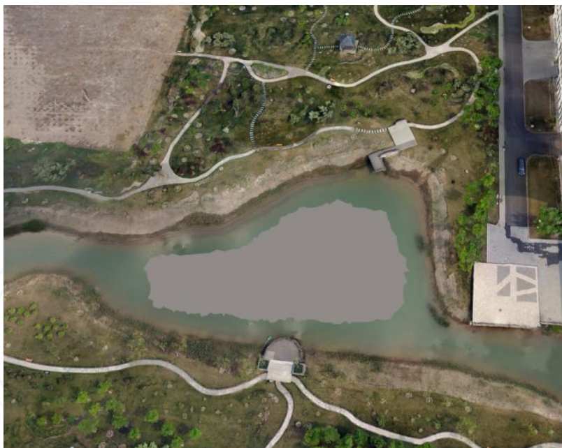
水域孔洞区域修复后使用Pixel-Mosaic进行纹理贴图
