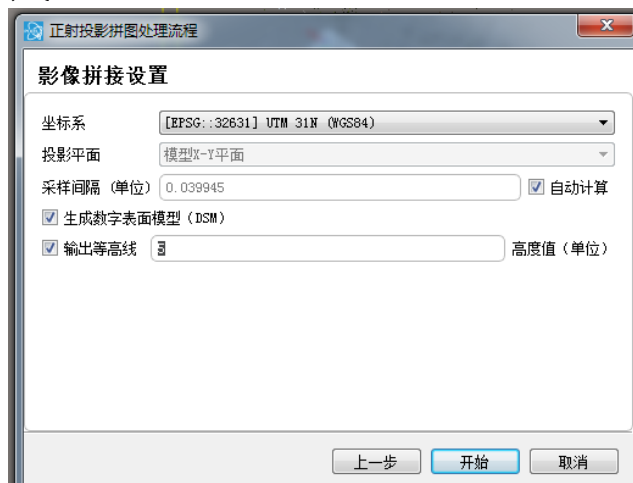
图 47 影像拼接参数设置
