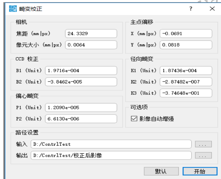
图 89 畸变校正参数设置
