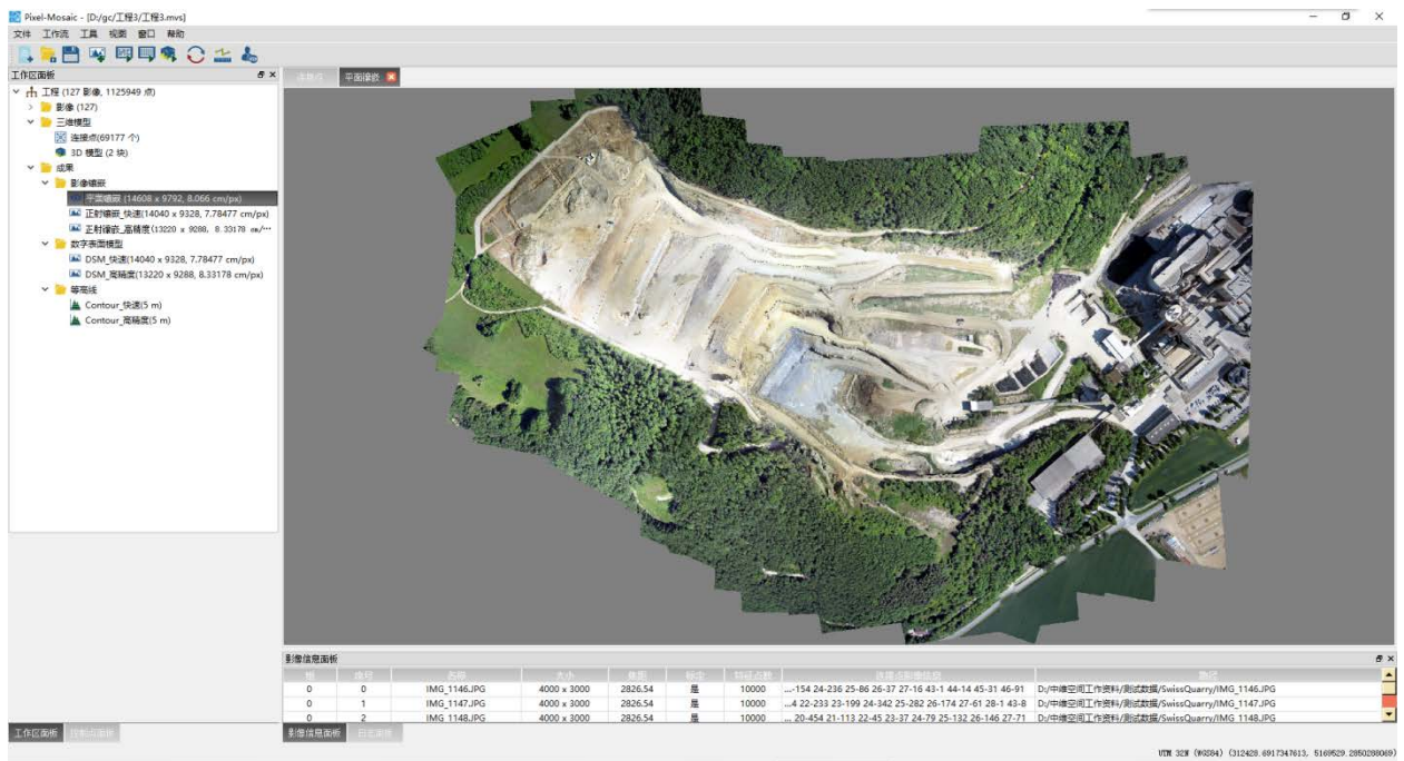
图 123 正射校正快速拼图
