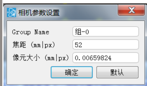
图 35 相机参数设置
