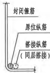
图11 封闭箍筋转角位置 (转角处无弯钩)
