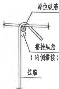
图12 拉筋弯钩位置
