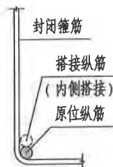
图11 封闭箍筋转角位置 (转角处无弯钩)
