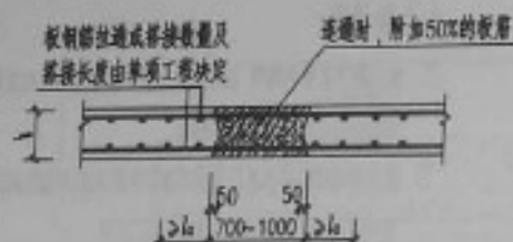
现浇板后浇带配筋构造
