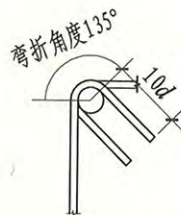
图4.12-4 受扭梁箍筋弯钩
