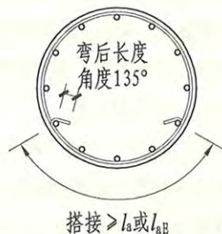
图1.17-3 圆形箍筋
