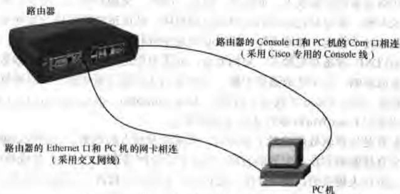
图 8-1 路由器软件升级连接图
