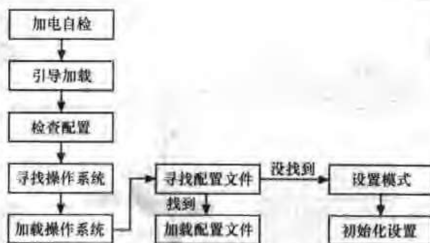
图 4-8 交换机启动流程
