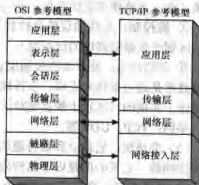
图 1-15 OSI 模型和 TCP/IP 模型的对应
