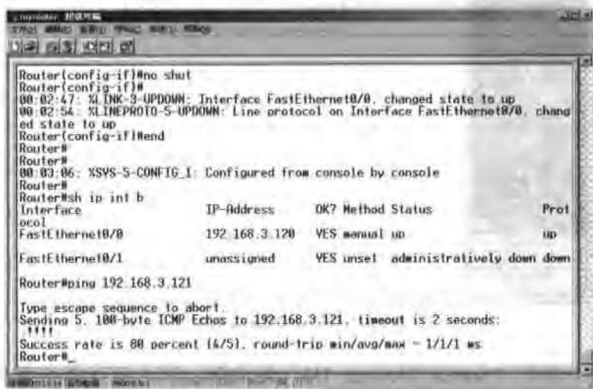
图 8-19 分在同一网段的路由器接口 IP 地址及快速以太网口 IP 地址
