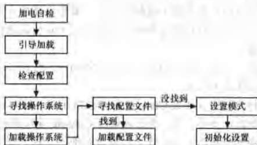
图 5-3 路由器启动流程
