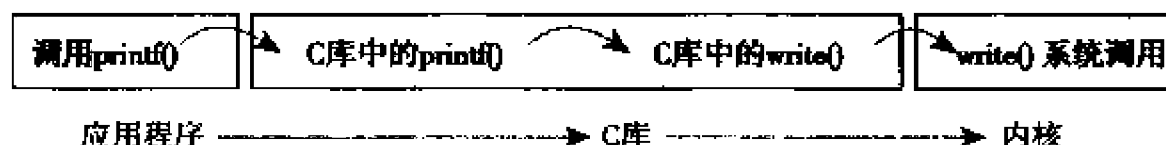
图 5-1 调用 printf() 函数时，应用程序、C 库和内核之间的关系
