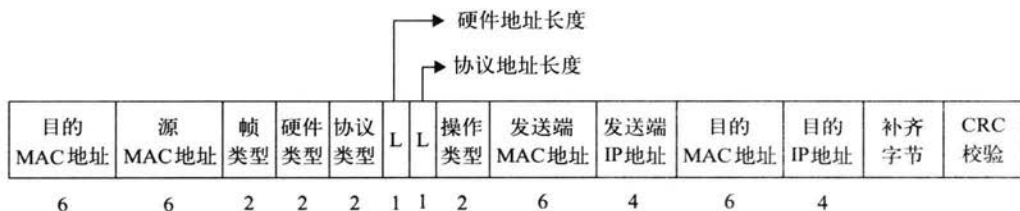
图 9.5 ARP 请求或应答数据报格式
