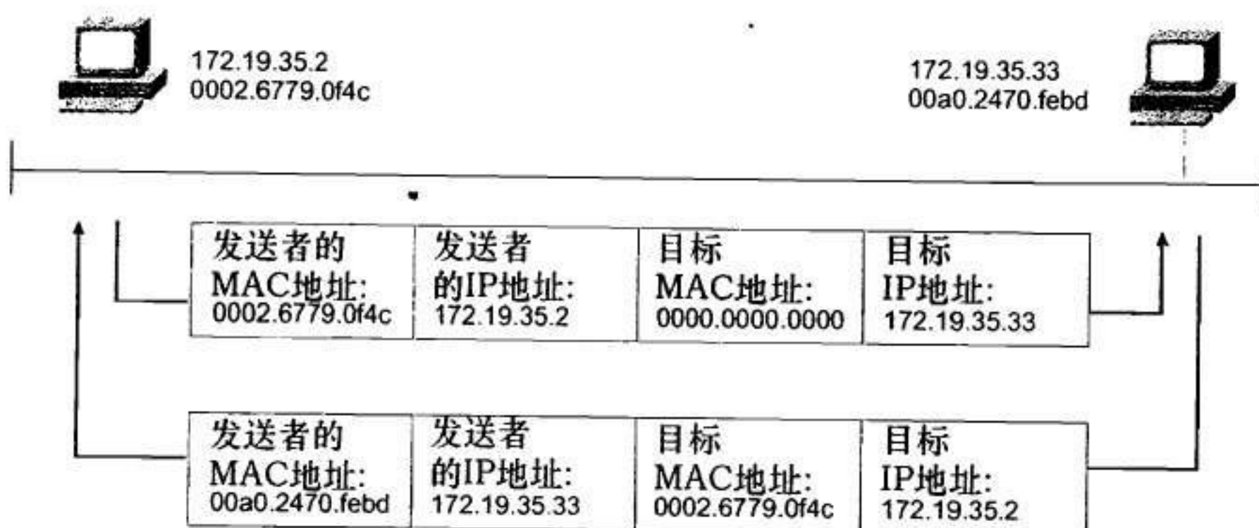
图 2-20 ARP 用于把设备的数据链路标识映射到它的 IP 地址上
