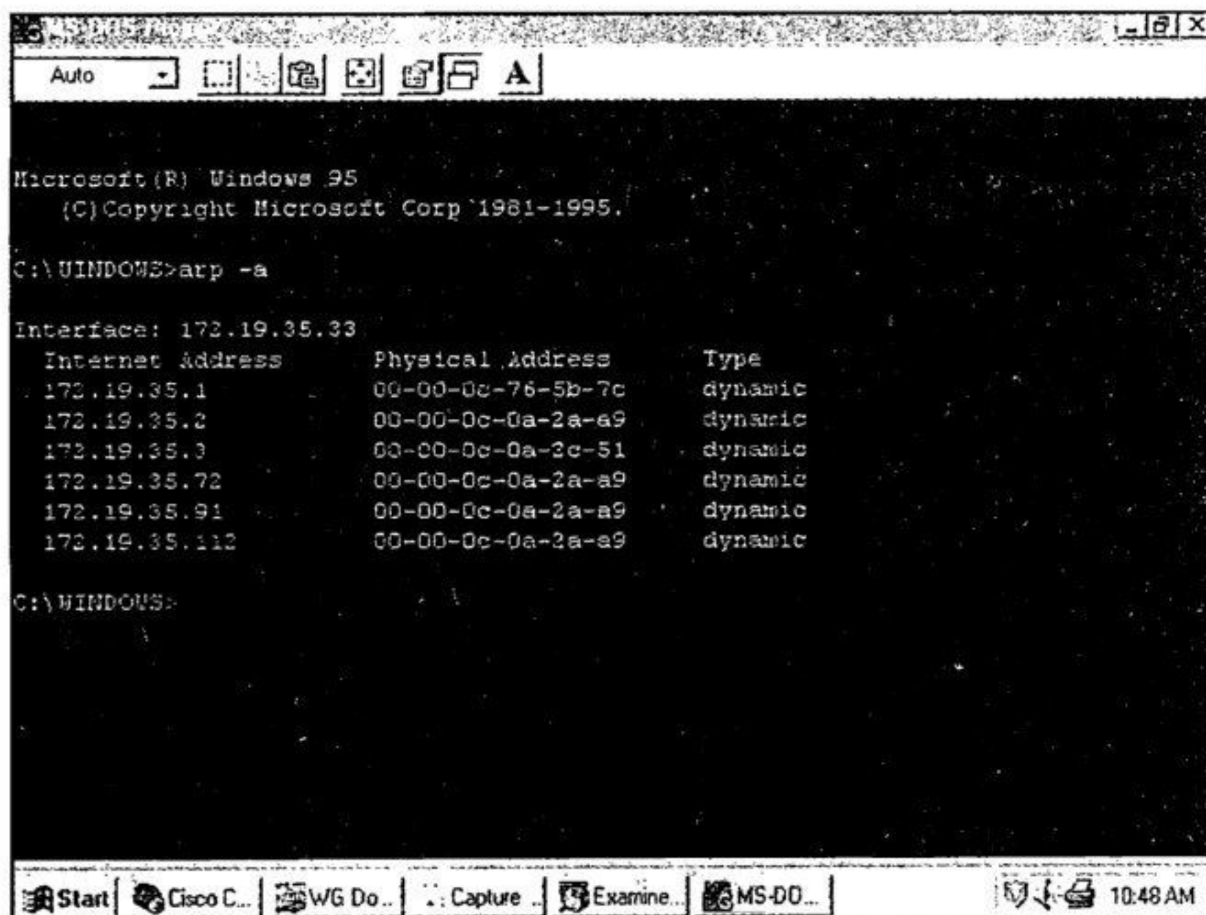
图 7-23 主机 B 的 ARP 缓冲区显示，主机 C 的 IP 地址被映射到了路由器 San_Felipe 的本地接口 172.19.35.2 的 MAC 地址上
