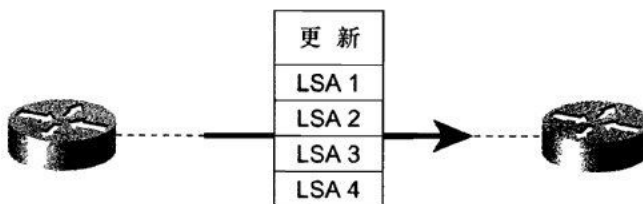
图 9-17 LSA 可以在链路状态更新报文里面发送，从而穿过节点之间的邻接
