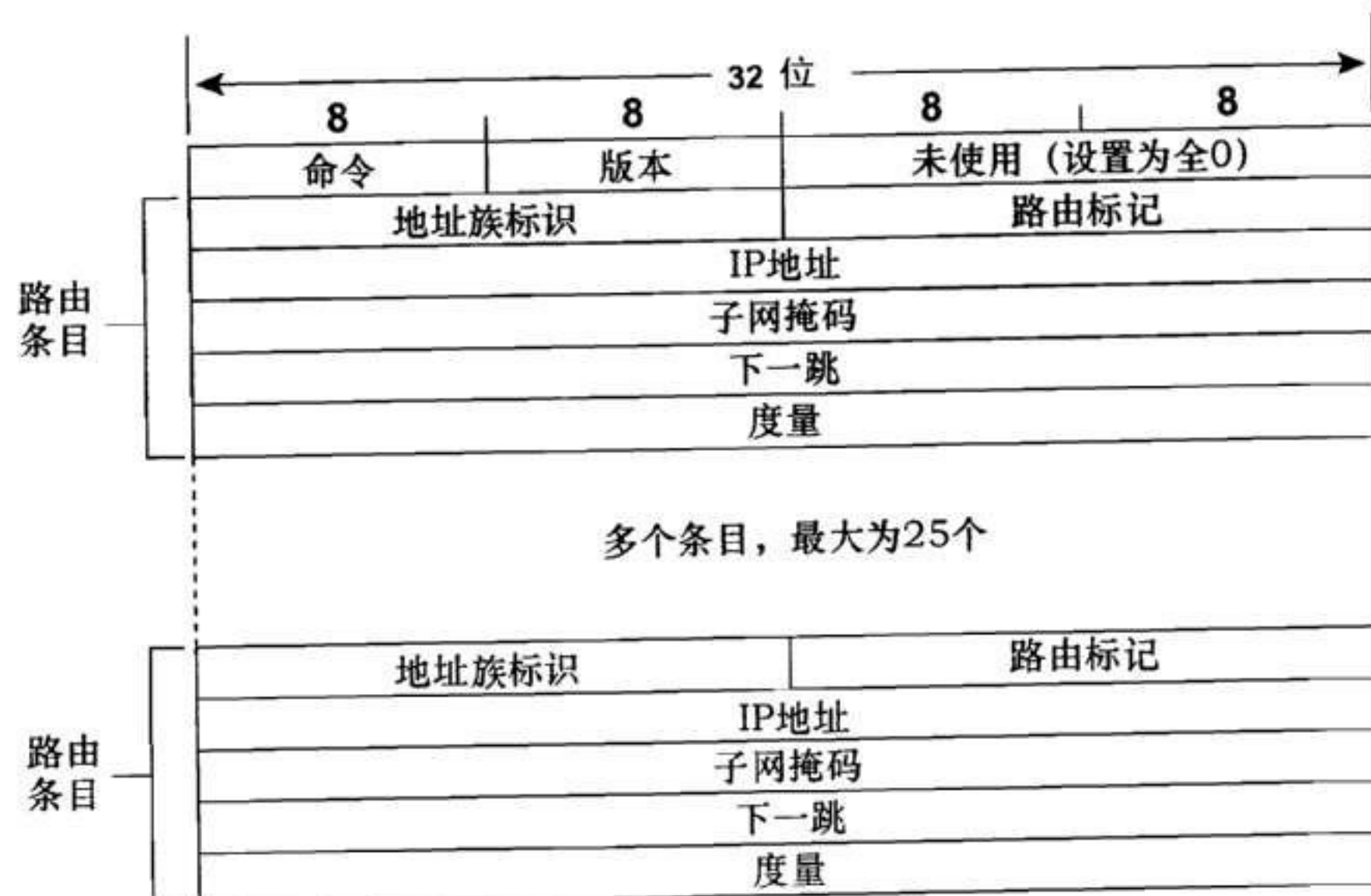
图 7-1 RIPv2 利用了版本 1 的消息格式中的未使用字段, 因而这些扩展没有改变版本 1 的基本消息格式
