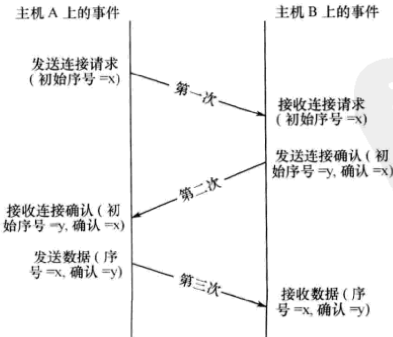
图 10-13 TCP 连接建立过程
