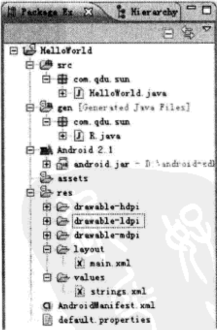
图 2-42 Android 项目架构
