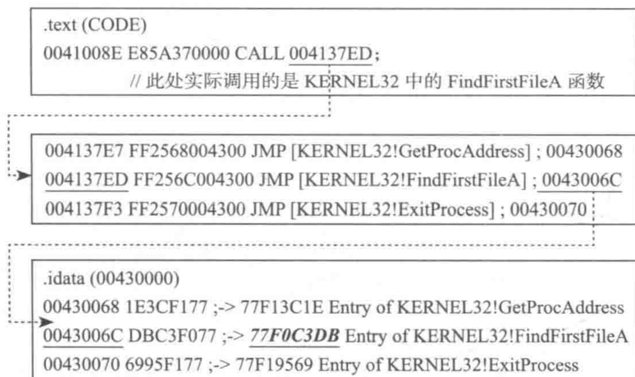
图 13-1 通过导入表实现的库函数调用目标识别示例
