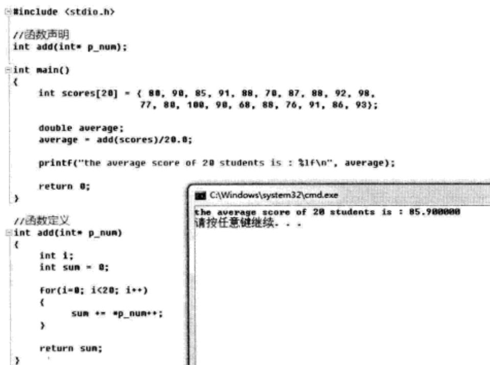
图 11.10 使用指针作为函数参数
