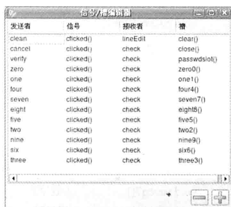
图11-17 数字按钮信号和槽的连接
