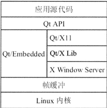
图11-5 Qt/Embedded与Qt/X11的Linux版本的比较
