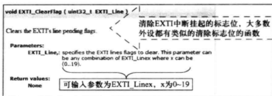
图 7-6 EXTI 清除标志位函数
