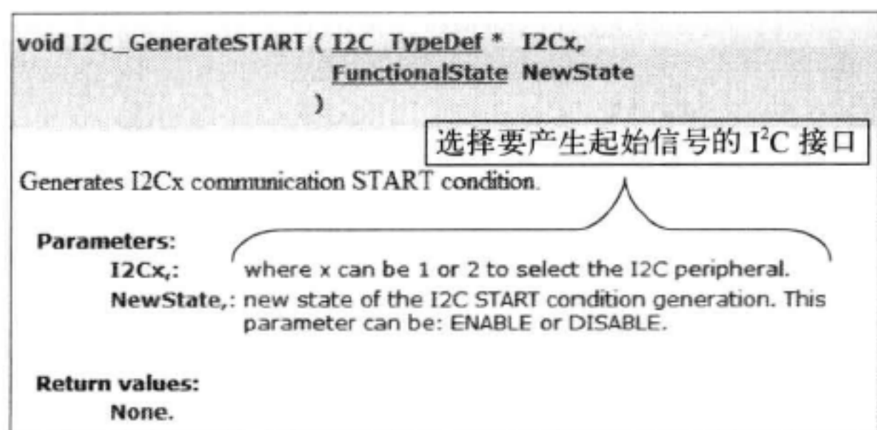
图 14-9 I2C GenerateSTART 函数说明
