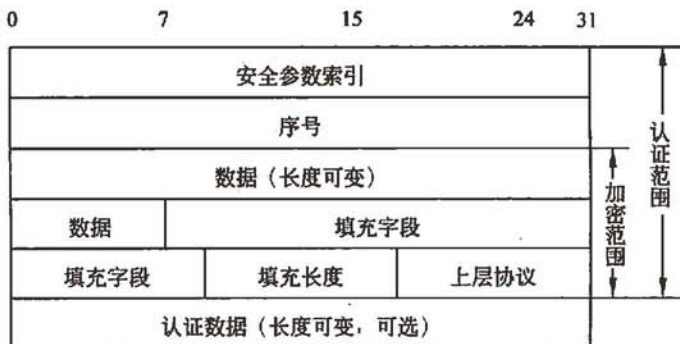
图 4-90 ESP 头的格式
