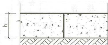
① 纵向缩缝（平头缝） 3-6m
