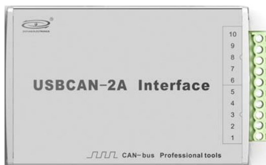
图 1 USBCAN-2A 双路工业级 CAN 接口卡
