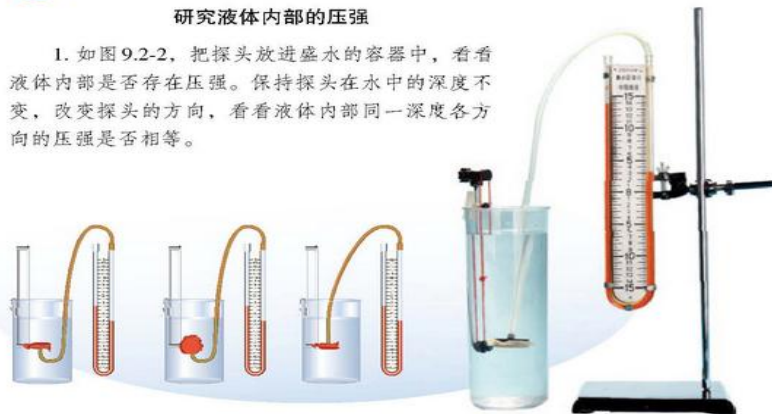
图9.2-2 同一深度液体向各个方向的压强是否相等？
