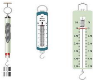
图7.2-2 弹簧测力计
