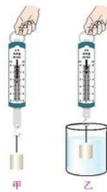
图10.1-2 测量铝块所受的浮力
