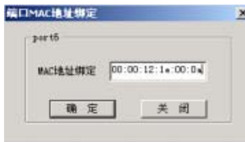
图 8-13 端口与 MAC 地址绑定
